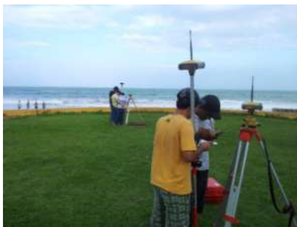
Figura 11: Equipe técnica instalando os receptores nas bases. Fonte: O autor
