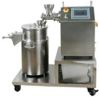
Um ciclo típico de **esferonização** consiste em processar uma quantidade pré-determinada de produto de extrusão até que sejam alcançados a forma e o grau de **esferonização** desejados.
