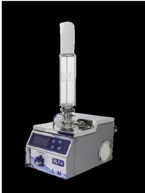
O termo fluidização é usado para designar uma operação em que sólidos particulados são suspensos por uma corrente ascendente de ar ou de outro fluido. Quando isto acontece, o leito de partículas passa a comportar-se como um fluido, principalmente no que tange às suas propriedades de escoamento, adquirindo um comportamento reológico de líquido.
