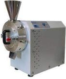
O Moinho de facas é um equipamento utilizado **para a moagem de amostras secas**, que são reduzidas para se obter uma análise mais detalhada.
