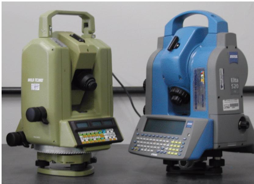
Foto 01 - Estação total Leica TC2002 e Estação total Elta S20 Point
