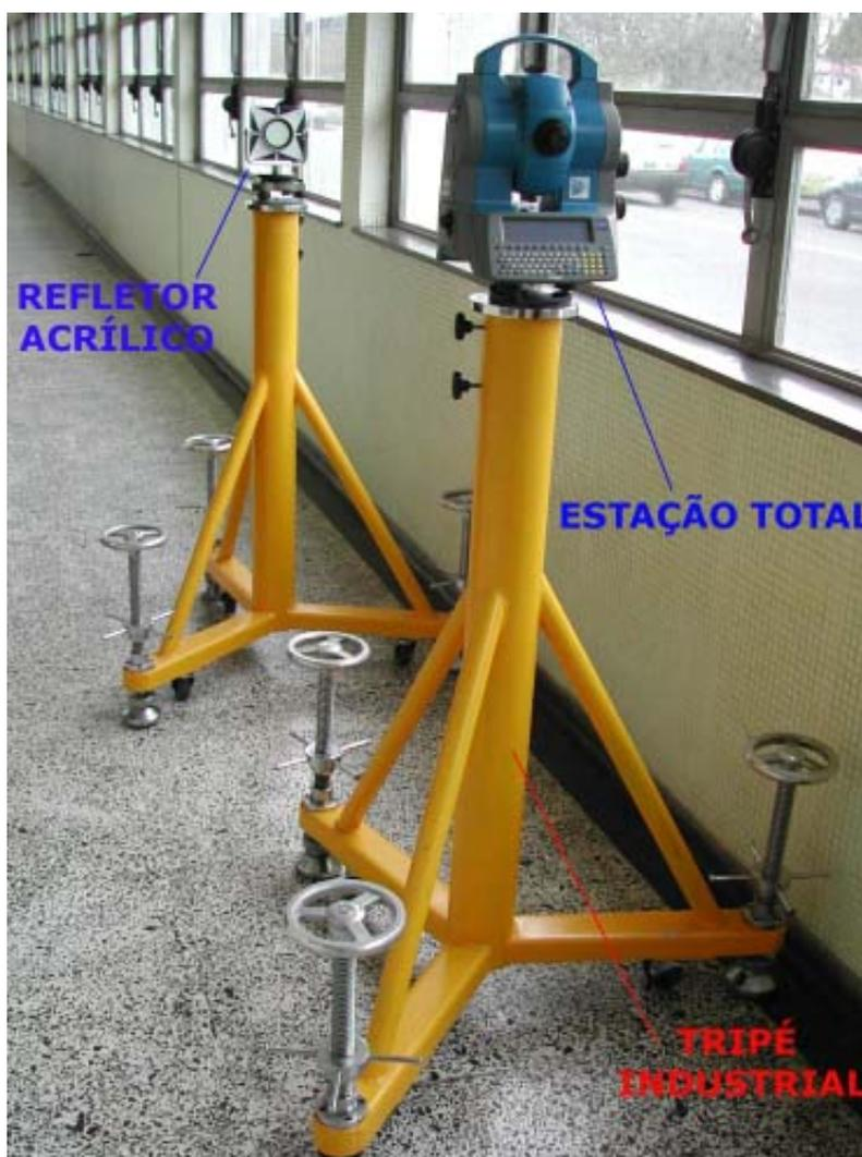
FOTO 06 – Determinação das constantes dos refletores no corredor do bloco VI
