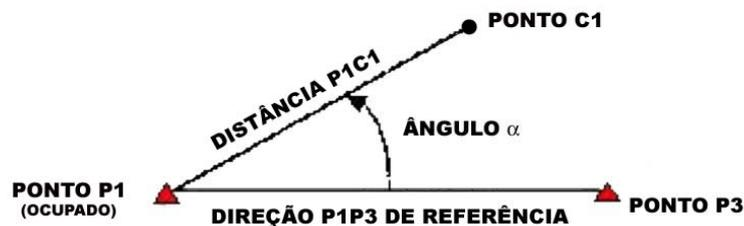
Figura 05 - Processo de irradiação.
