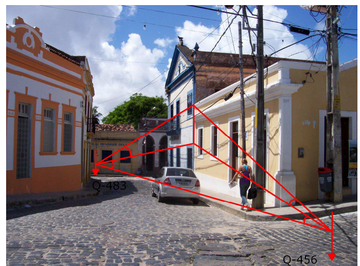
Figura 4 – Tetraedro que representa a interseção à vante na área em estudo
