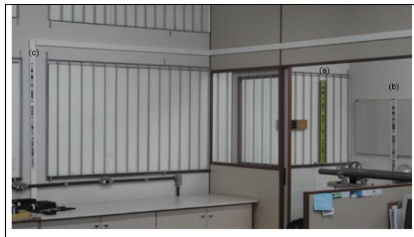
Figura 7 – Disposição dos alvos no Laig: Ré (A) , Vante 1 (B) e Vante 2 (C)
