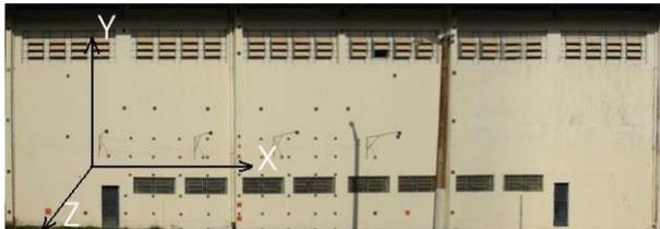
Figura 04 – Sistema de coordenadas cartesianas e pontos de orientação (vermelhos) e pontos de calibração (preto).
