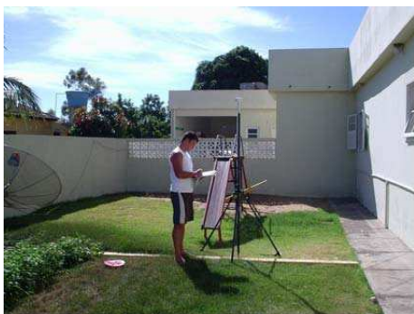
Figura 3: Levantamento geodésico no campo – estação Rover “PU_Mato_Escuro”.
