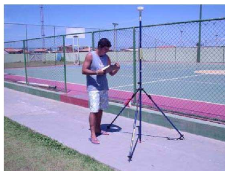
Figura 2: Levantamento geodésico no campo – estação Base “PU_Açú”.
