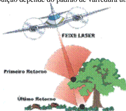
Figura 1 - Reflexão do primeiro e último retorno (BRANDALIZE, M. C., 2004).
