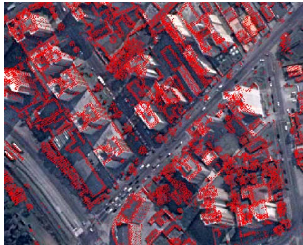
Figura 04. Resultados da seleção de pontos laser que descrevem os limites das edificações
