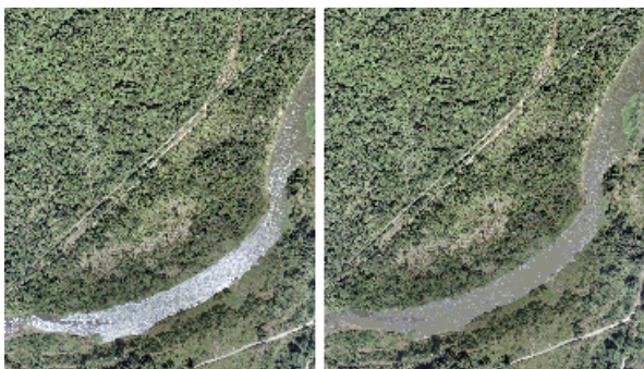
Figura 1. Exemplo de correção de reflexo do sol em corpos d'água na fotografia da direita (Fotografia: Engefoto S/A)
