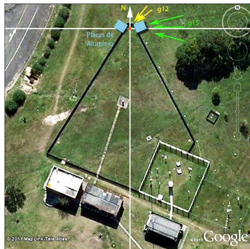
Figura 8 - Croqui do local de rastreo e a estimativa da incidência dos sinais dos satélites G12 e G15
