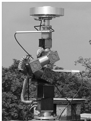
Figura 4 - Calibração Absoluta com dispositivo automatizada da antena Leica AR25 (HUINCA E KRUEGER,2011).
