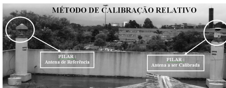
Figura 2 – Calibração Relativa em Campo (HUINCA E KRUEGER, 2011).
