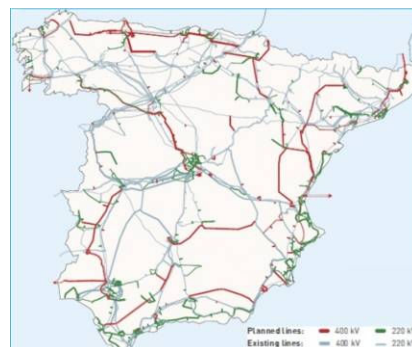
Figura 1. Red de transporte de energía eléctrica de alta tensión en el territorio peninsular español (adaptado desde (Red Eléctrica de España. 2011c))
