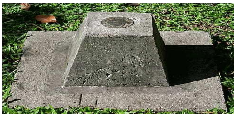
Figura 3- Marco de concreto, estação base do IBGE.
