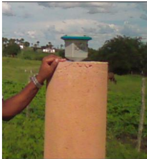
Figura 4- Base materializa e fixada/ aparelho de frequência L2. Fonte: Bezerra, A. E. Relatório final de conclusão de curso.
