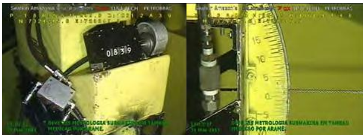
Figura 05 – Fotos com registro de distância (em pés) e ângulo vertical (Equipamento PMT da Oceanering)
