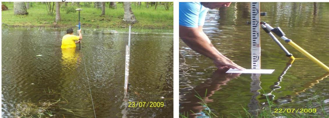
Fig. 03 – Batimetria em tempo real por GPS – geodésico com link de rádio e medições sobre a régua linimétrica.
