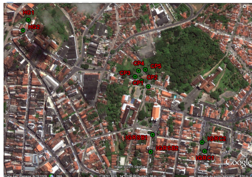
Figura 4 – Representação do Campo de pontos de referência determinados por levantamento GNSS.
