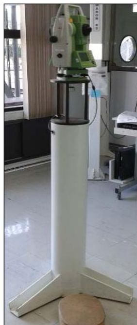
Figura 4 - Pilar de aço usado no Método Compacto.
