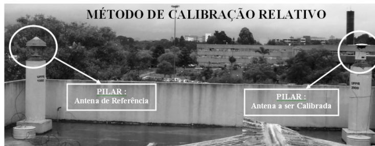
Figura 2 – Calibração Relativa em Campo (HUINCA E KRUEGER, 2011).
