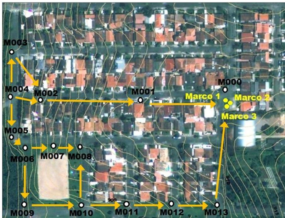
Figura 3 – Estrutura geodésica de monitoramento de área de estudo no Bairro de Guabirutuba, município de Curitiba, PR.
