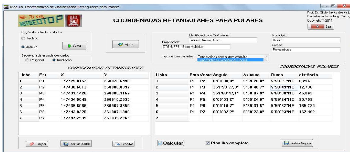
Figura 6 – Transformação de coordenadas retangulares para polares no modo irradiação. Fonte: AstGeoTop(2014). Versão do módulo: copyright 2011.
