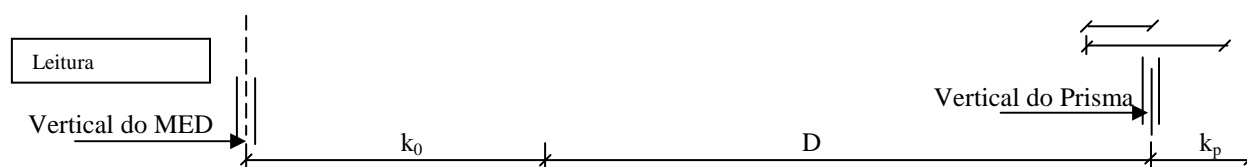
Figura 2 – Medida de distância eletrônica pelo princípio da comparação da fase Fonte: Adaptada de Paciléio Netto (1990); Kahmen & Faig (1988); Rueger (1990)
