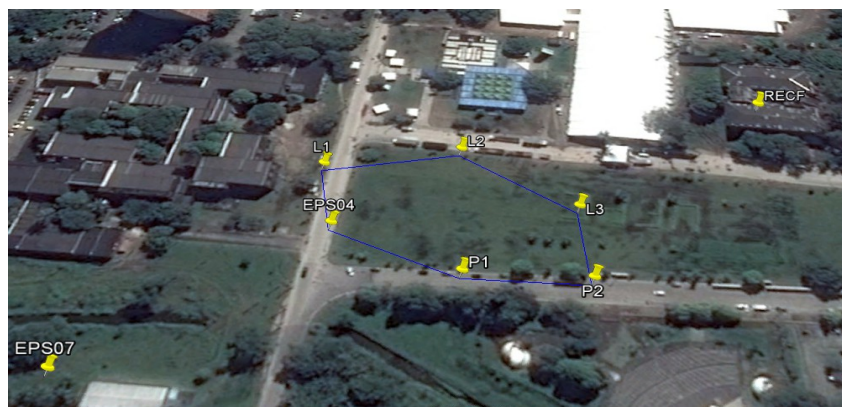
Figura 6 – Vértices (EPS04, L1, L2, L3, P2 e P1) da poligonal implantada. Fonte: AstGeoTop2013 & Google Earth2013.
