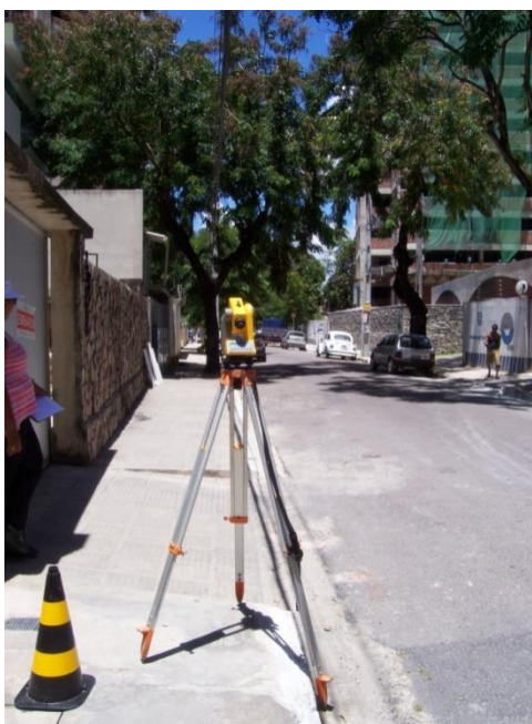
Figura 2 – Exemplo de vértice temporário, próximo à edificação.
