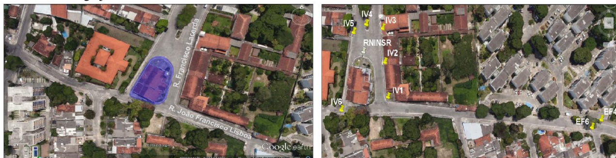
Figura 2 - À esquerda, tem-se a Igreja Nossa Senhora do Rosário em destaque com hachura azul. À direita, tem-se a localização dos vértices da poligonal implantada (IV1, IV2, IV3, IV4, IV5 e IV6), os dois pontos de apoio topográfico (EF4 e EF6) e a RNINSR. Fonte: Adaptada Imagem Google Earth (2016).
