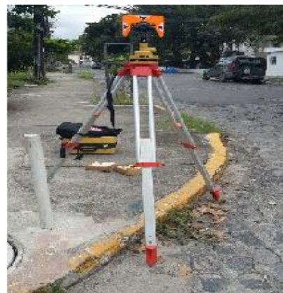
Figura 3- Método da interseção a ré por medições combinadas de direção e distância. Foto: abril de 2015 – Vértice EF6.
