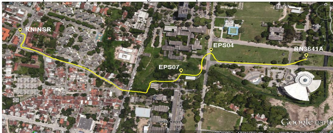
Figura 3. Percurso realizado para o nivelamento geométrico composto, seguindo a sequência: RN3641A, CHEPS04, CHEPS07, RNINRS, CHEPS07, CHEPS04 e por fim RN3641A. Fonte: Adaptada Google Earth (2016).
