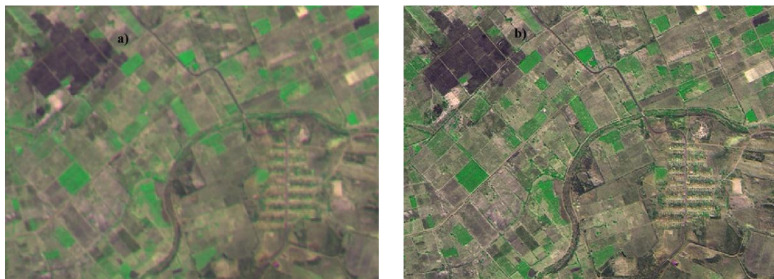
Figura 6 – Feições lineares e áreas de agricultura irrigada. a) Antes da fusão, b) depois da fusão.
