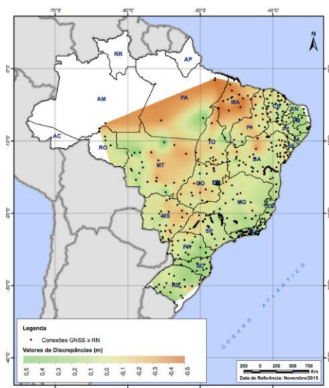
Figura 3 – Mapa das discrepâncias entre a ondulação geoidal real e a fornecida pelo MAPGEO2015. Adaptado de: IBGE, 2015.
