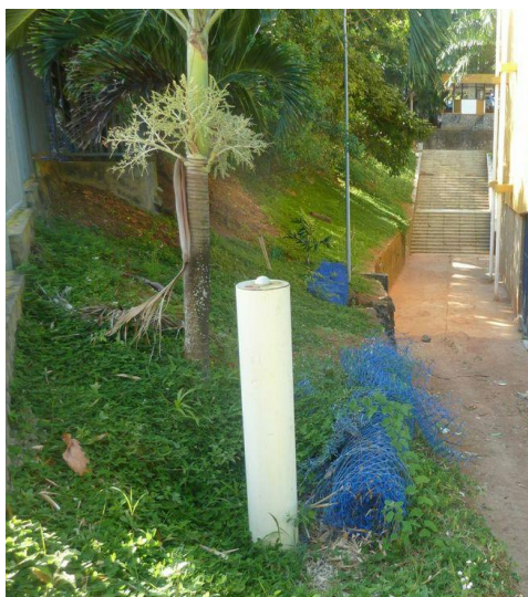
Figura 1 – Pilar de centragem forçada implantado na Escola Politécnica da UFBA
