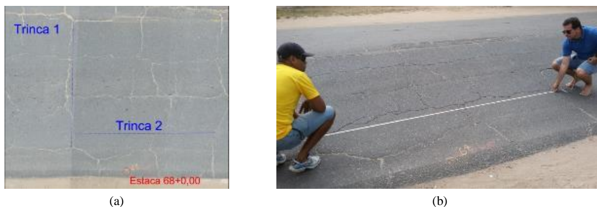
Figura 9 – (a) Medição no software sobre o mosaico e (b) levantamento da extensão longitudinal da trinca em campo
