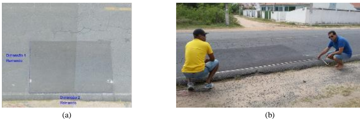
Figura 8 – (a) Medição no software sobre o mosaico; (b). Levantamento da extensão longitudinal remendo em campo
