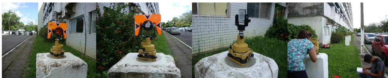
Figura 05 a e b – Prisma circular óptico utilizado nas medições com e sem refletor; c e d – Folha reflexiva utilizada nas operações de campo e a base multipilar da UFPE
