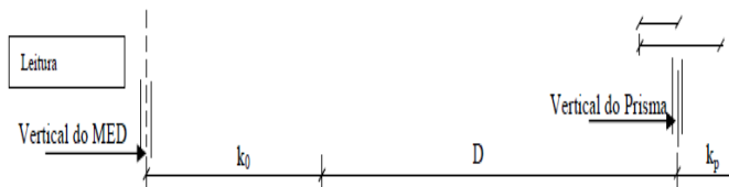
Figura 04 - Medição eletrônica de distância, pelo princípio da diferença de fase. Fonte: Apud (GARNÉS et al., 2014).
