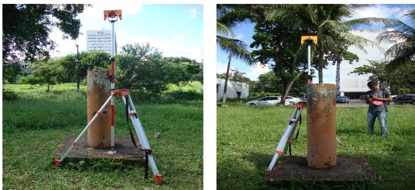
Figura 09 – Marco Geodésico EPS07 e chapa de referência altimétrica CHEPS07 utilizada neste trabalho
