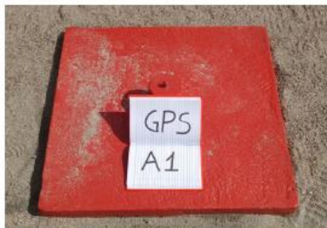
Figura 3 – Estação de Referência
