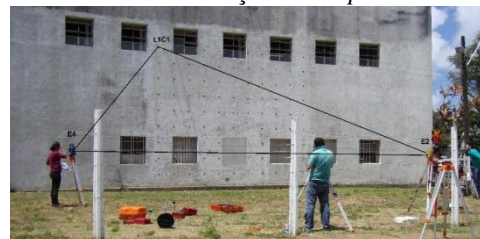
Figura 3 – À esquerda, os elementos do triângulo e à direita, a configuração em campo na realização do método de interseção a vante.
